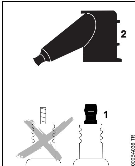
**!** Para reducir el riesgo de incendio y de quemaduras, utilice solamente las bujías autorizadas por STIHL. Siempre empuje el casquillo (2) de la bujía firmemente en el borne (1) del tamaño adecuado. (Nota: Si el borne tiene una tuerca adaptadora SAE desmontable, tiene que ser instalada.) Una conexión suelta entre el casquillo de la bujía y el conector del cable de encendido en el casquillo puede crear un arco voltaico y encender los vapores del combustible, provocando un incendio.
