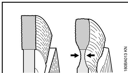
El socavamiento es el desgaste del núcleo de acero en los segmentos adiamantados o justo debajo de ellos. Cuando se cortan superficies pavimentadas, no corte más profundamente en la capa abrasiva (grava, piedra picada) bajo la superficie, la cual se indica porque produce un polvo de color claro. Esto causa un socavamiento excesivo, lo cual produce la rotura y/o el lanzamiento de segmentos del disco.
