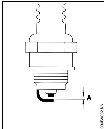
Si la mezcla del combustible es incorrecta (demasiado aceite en la gasolina), el filtro de aire está sucio, y las condiciones de trabajo no son favorables (especialmente a aceleraciones intermedias) se afecta la condición de la bujía. Estos factores permiten la formación de depósitos en la punta aislante, los cuales pueden perjudicar el rendimiento.
