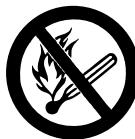
La gasolina es un combustible muy inflamable. Si se derrama y arde a causa de una chispa u otra fuente de ignición, puede provocar un incendio y quemaduras graves o daños a la propiedad. Tenga sumo cuidado cuando manipule gasolina o la mezcla de combustible. No fume cerca del combustible o la herramienta motorizada, ni acerque ningún fuego o llama a ellos. Puede escapar vapor inflamable del sistema de combustible.
